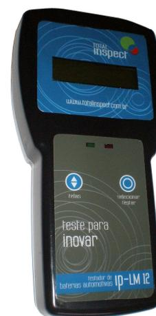
Na partida do motor, de modo automático, faz a aquisição da tensão de afundamento da bateria, permitindo “análise cruzada” com o teste da bateria, bem como identificar mau contato e/ou zinabre nas suas conexões.
